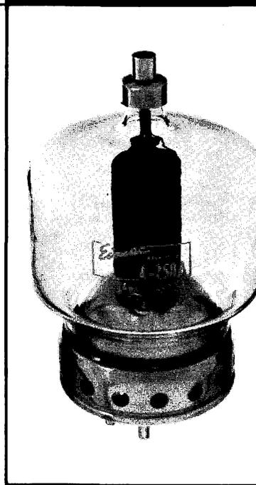
**RADIO FREQUENCY POWER AMPLIFIER AND OSCILLATOR**
