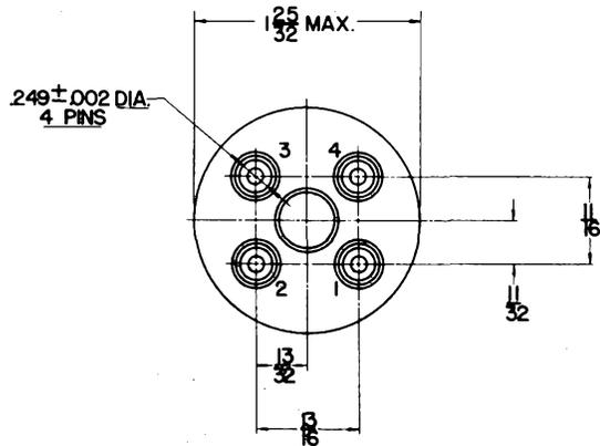
\*ON FINISHED TUBE ADD .060 FOR SOLDER
