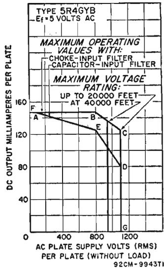
OPERATING AREAS FOR SIMULTANEOUS AND DELAYED APPLICATION OF PLATE VOLTAGE
